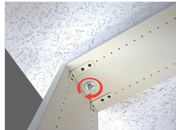
金具Bを凸面が上向きになるように金具Aに取付けます。このとき金具Bを**手で回し止まるまで**締め付けてください。
