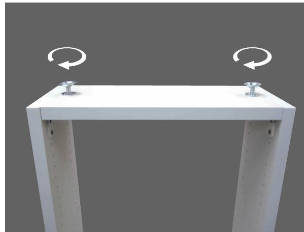
穴あき棚板の台座金具に金具Aをぐらつかない程度までネジ込んで仮付けします。
