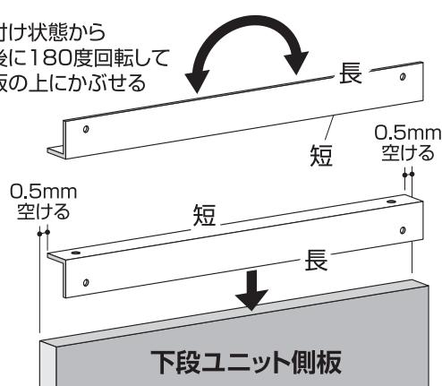
【注意】レールの取り付け向きにより、図の側板の左右が異なります。
