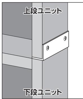
側板の内側の凹凸を無くしフラットにする場合の取り付け方
