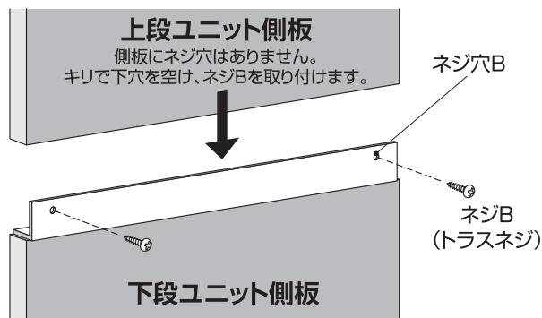
【注意】レールを隠す取り付けの場合ネジ穴Bは内側、レールを露出する場合ネジ穴Bは外側になります。
