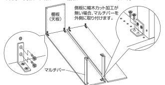
【幅木カット加工をした側板の場合】 カット側のマルチバーを内向きに取り付けます
